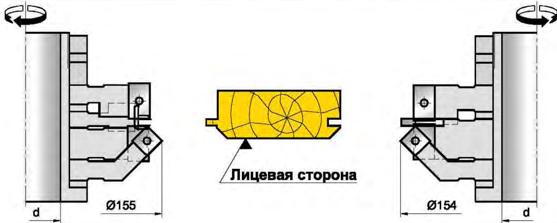
41 Доска пола - вагонка S=4 мм
