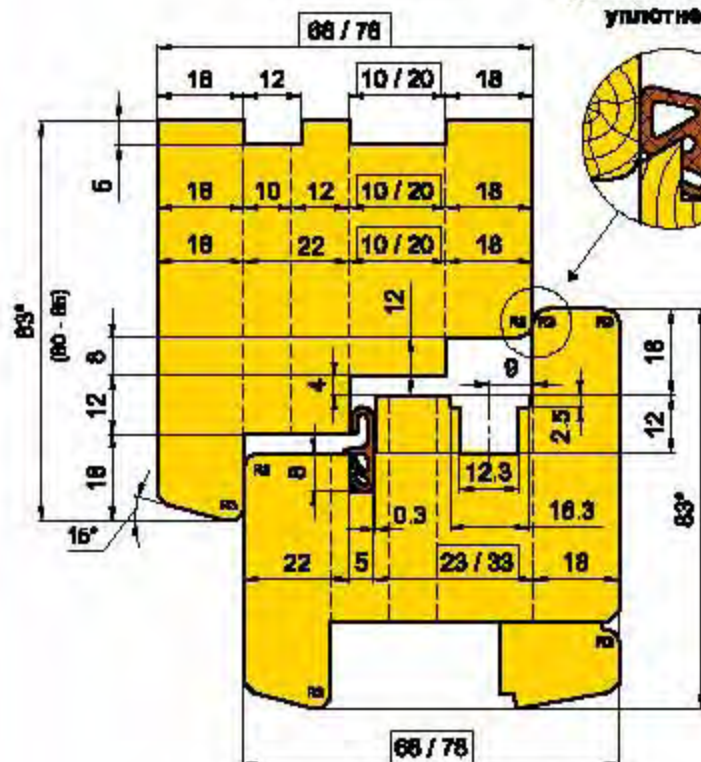
Вертикальное сечение оконного блока
